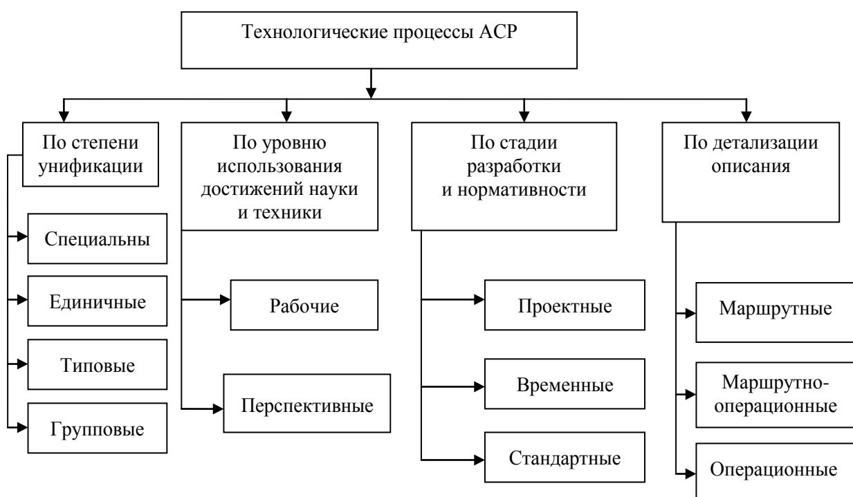
Рисунок 3 – Классификация технологических процессов аварийно-спасательных работ
